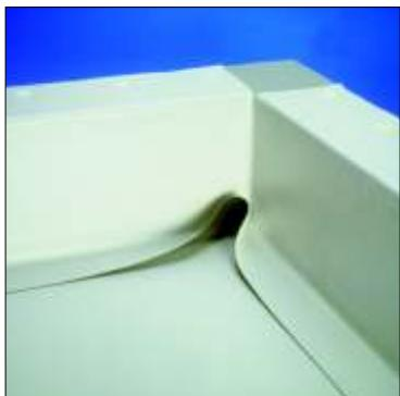
Уложите полосы мембранны Sikaplan® на парапете и временно закрепите их вверху. В качестве альтернативы можно приварить полосы мембранны Sikaplan® непосредственно на полосы ламинированной жести Sika-Trocal®. Если высота парапета превышает 50 см, необходимо механически закрепить полосы мембранны на вертикальной поверхности. (См. главу 4.14.)
