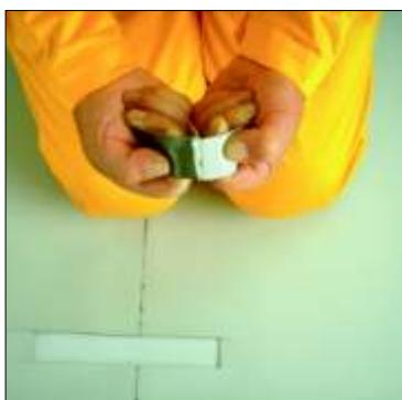
Остывший сварной шов должен выдержать ваше испытание на разрыв. Мембранны с внутренним армированием могут расслаиваться при испытании.
