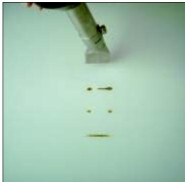
Нагрейте сварочный аппарат до рабочей температуры и поднесите его к мемbrane таким образом, чтобы сопло горячего воздуха находилось на расстоянии около 5 мм от поверхности мембраны параллельно её плоскости .
