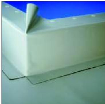
Изолируйте парапет полосой мембранны **Sikaplan®**. Вначале закрепите ее прихватками к горизонтальной поверхности мембранны вдоль парапета по углу перегиба. Затем полностью приварите полосу мембранны **Sikaplan®** на поверхность кровли. Обратите внимание: ширина нахлеста зависит от типа механического крепления по периметру и должна составлять не менее 12 см (см. главу 4.14.).
