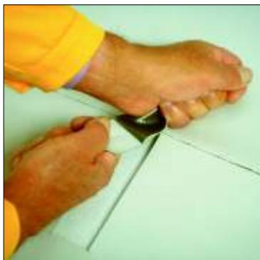
В случае сомнения в прочности шва, проведите выборочную проверку качества шва испытанием на разрыв.
